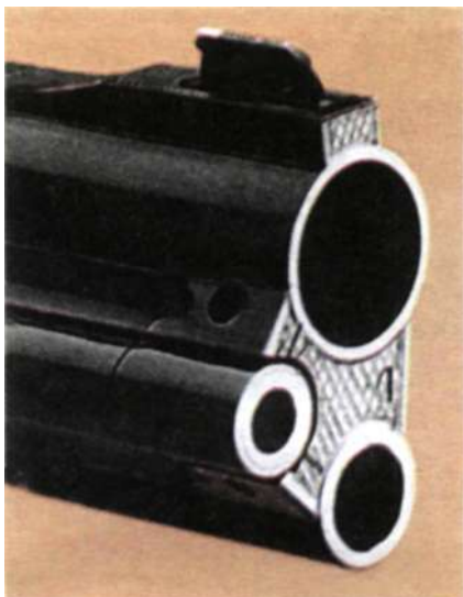
Один из вариантов соединения трех стволов
